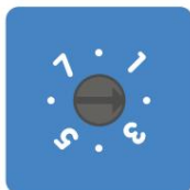
Otočný přepínač nastaven do polohy 2
